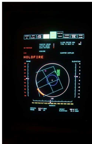
Sie wurde durch zwei digital erstellte Displays ersetzt (Argus 700) Zieldaten und Störungsbeurteilung
